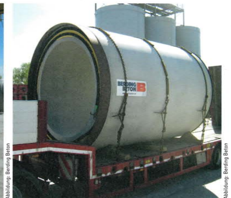
Insgesamt 573 Betonteile mussten per Lastzug zur Baustelle transportiert werden.
