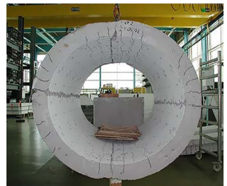
VERSAGENSMECHANISMEN AN VORTRIEBSROHREN
