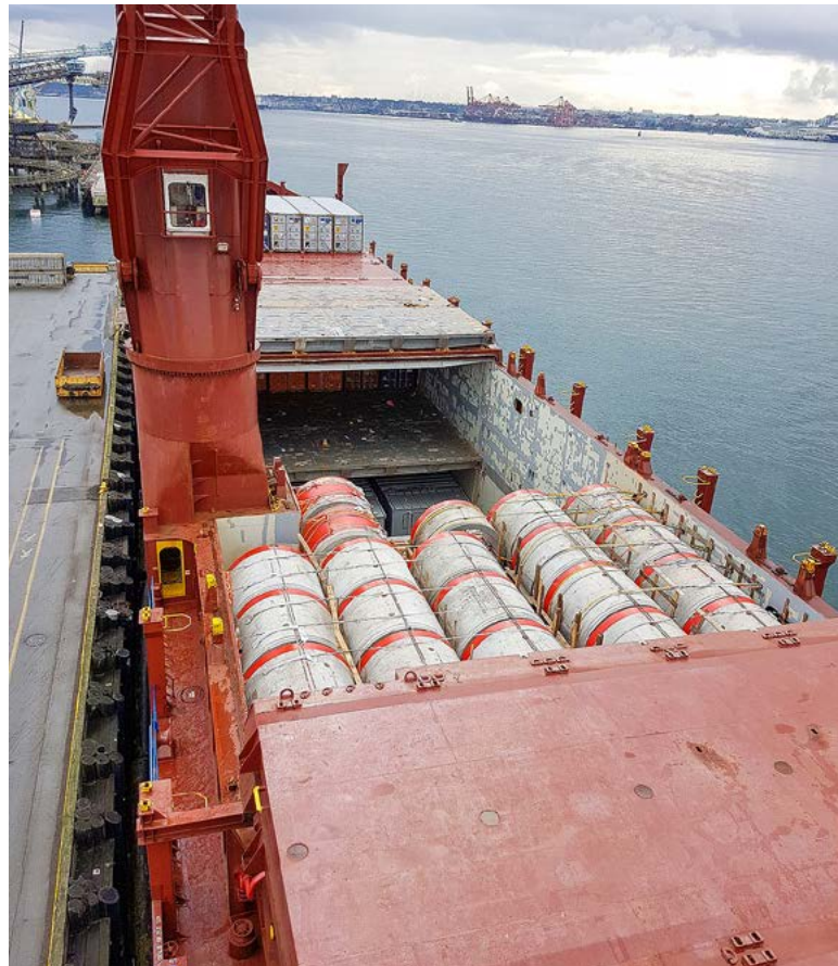
SCHIFFSTRANSPORT VON VORTRIEBSROHREN (VANCOUVER, BC)
