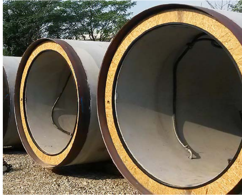
DRUCKÜBERTRAGUNGSRING (DÜR) AUS HOLZWERKSTOFF
