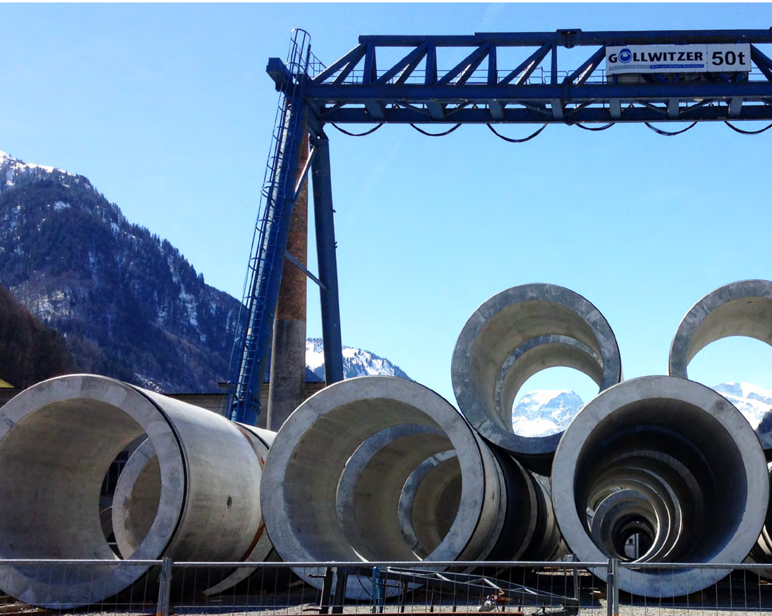
VORTRIEB KRAFTWERK COTLAN, RÜTI (CH): FELDFABRIK FÜR VORTRIEBSDROHRE
